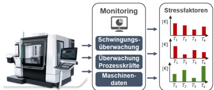
Abbildung 1: Belastungsorientiertes Bezahlmodell am Beispiel einer Werkzeugmaschine
